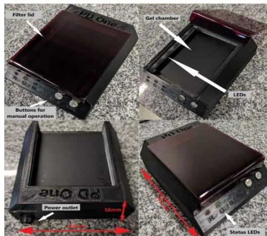
Gambar 4 : Perakitan akhir sistem s. Panah putih menunjukkan tutup filter, LED status, ruang gel, stopkontak, dan tombol "SET" dan "OK" untuk pengoperasian sistem secara manual.
